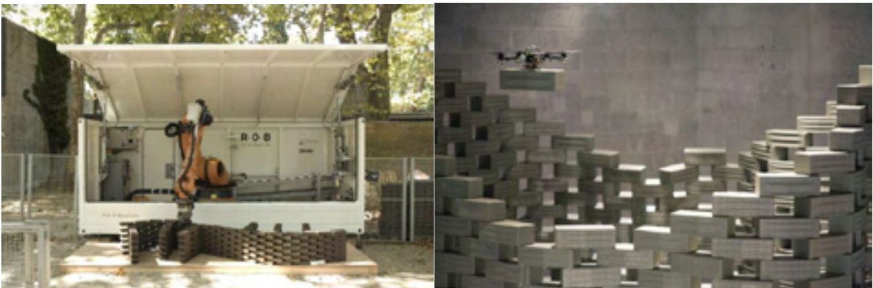
Εικόνα 1: Ρομποτικές διατάξεις χτισίματος τούβλων
