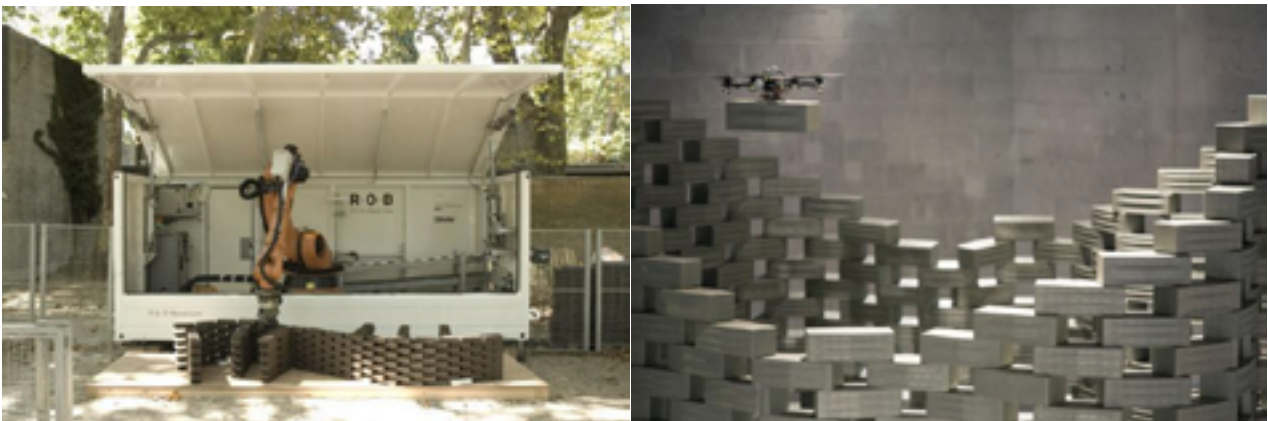
Εικόνα 1: Ρομποτικές διατάξεις χτισίματος τούβλων
